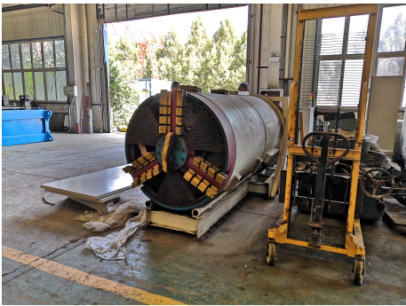
图 2 Φ1 200 mm 土压平衡盾构机 Fig.2 Φ1 200 mm earth pressure balance shield
